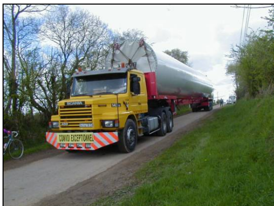
Photos n° 3 et n° 4 : Vues du camion approvisionnant une portion du fût d'une éolienne
