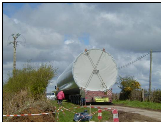
Photos n° 3 et n° 4 : Vues du camion approvisionnant une portion du fût d'une éolienne
